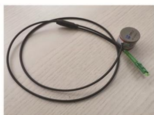
低温环境光纤声发射传感器
